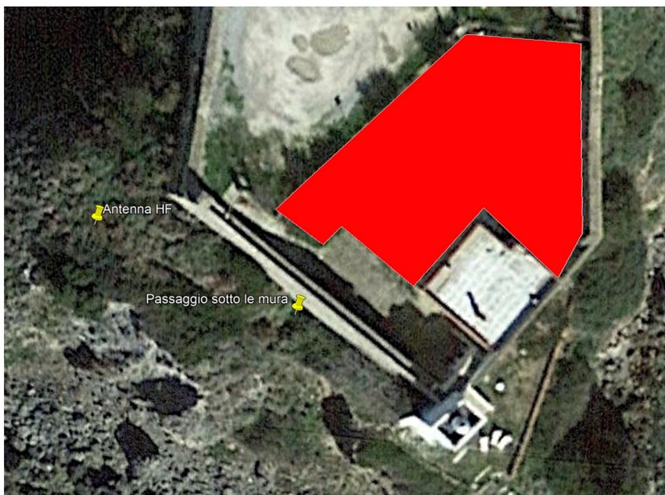
Nella seconda ipotesi, installazione all'interno della Rocca Aldobrandesca di Talamone (area rossa nella figura sottostante), con l'installazione eventuale di un condizionatore, se ritenuto necessario. I cavi di segnale che collegheranno antenna ed elettronica, scorreranno ai piedi delle mura, saranno nascosti e saranno fatti entrare nella Rocca secondo modalità concordate con gli Enti competenti. La lunghezza dei cavi sarà di circa 150-160 m.
